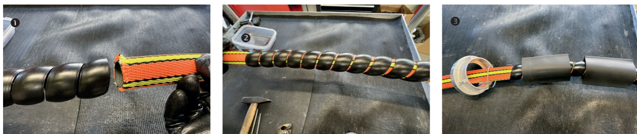
1+2 Kunststoffknickschutzspirale über den Schlauch ziehen, dabei vorsichtig die Spirale leicht aufdrehen 3 dann Knaggenteil, Sperring und 2 Schrumpfschläuche über den Schlauch ziehen.
