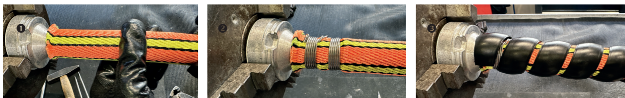
1 Stutzen in die dafür vorgesehene Vorrichtung einspannen + Schlauch ganz auf Stutzen schieben 2 1,8 mm Draht mit 2 x 6 Windungen wickeln mit einer Verbindungskette zwischen den 2 Einbindefeldern 3 dann die Kunststoffknickschutzspirale bis zum Stutzen vorne über den Drahteinband ziehen.
