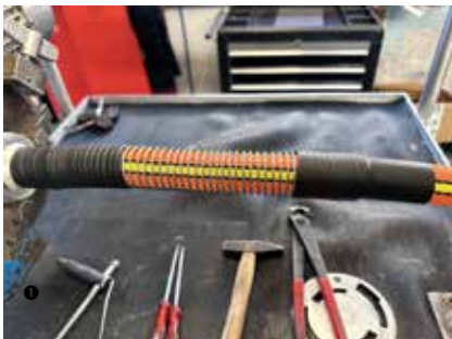
① Schrumpfschläuche müssen am Stutzen vorne an der Metallknickschutzspirale und zur Hälfte über das Ende der Metallknickschutzspirale verschmolzen sein ② Fertig eingebundener GH TEXFLEX X-TREME.
