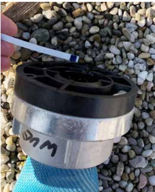
Nachweis des Desinfektionsmittels am Ende des Schlauchs
