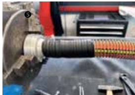
① Metallknickschutzspirale über den Schlauch ziehen, dabei vorsichtig die Spirale leicht aufdrehen ② Knaggeteil, Sperring und 2 Schrumpfschläuche über den Schlauch ziehen ③ 1,8 mm Draht mit 2 x 6 Windungen wickeln, mit einer Verbindungskette zwischen den 2 Einbindefeldern ④ Schrumpfschläuche auf die Metallknickschutzspirale am Knaggeteil vorne und am Ende der Spirale aufschieben ⑤ mit einer Heißluftpistole den Schrumpfschlauch langsam erhitzen ⑥ Nun im Endbereich der Metallknickschutzspirale einen Schrumpfschlauch aufsetzen und auch mit der Heißluftpistole langsam erhitzen.
