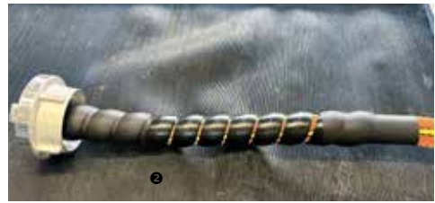
① Knaggeteil und den Sperring fest montieren ② Fertig eingebundene Seite mit der Kunststoffknickschutzspirale
