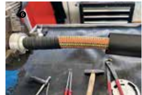
① Metallknickschutzspirale über den Schlauch ziehen, dabei vorsichtig die Spirale leicht aufdrehen ② Knaggeteil, Sperring und 2 Schrumpfschläuche über den Schlauch ziehen ③ 1,8 mm Draht mit 2 x 6 Windungen wickeln, mit einer Verbindungskette zwischen den 2 Einbindefeldern ④ Schrumpfschläuche auf die Metallknickschutzspirale am Knaggeteil vorne und am Ende der Spirale aufschieben ⑤ mit einer Heißluftpistole den Schrumpfschlauch langsam erhitzen ⑥ Nun im Endbereich der Metallknickschutzspirale einen Schrumpfschlauch aufsetzen und auch mit der Heißluftpistole langsam erhitzen.
