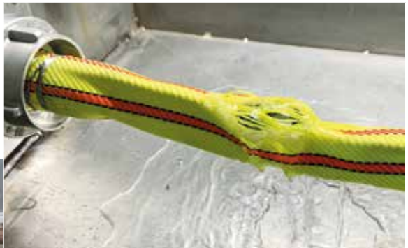
Ohne Abrieb geplatzter Feuerlöschschlauch
