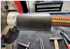
① Metallknickschutzspirale über den Schlauch ziehen, dabei vorsichtig die Spirale leicht aufdrehen ② Knaggeteil, Sperring und 2 Schrumpfschläuche über den Schlauch ziehen ③ 1,8 mm Draht mit 2 x 6 Windungen wickeln, mit einer Verbindungskette zwischen den 2 Einbindefeldern ④ Schrumpfschläuche auf die Metallknickschutzspirale am Knaggeteil vorne und am Ende der Spirale aufschieben ⑤ mit einer Heißluftpistole den Schrumpfschlauch langsam erhitzen ⑥ Nun im Endbereich der Metallknickschutzspirale einen Schrumpfschlauch aufsetzen und auch mit der Heißluftpistole langsam erhitzen.
