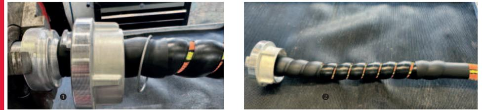
1 Knaggenteil und den Sperrring fest montieren 2 Fertig eingebundene Seite mit der Kunststoffknickschutzspirale
