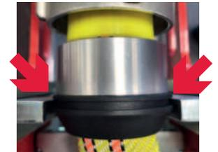
Die Nut des Außenrings muss formschlüssig in das Montagegerät eingesetzt werden.
