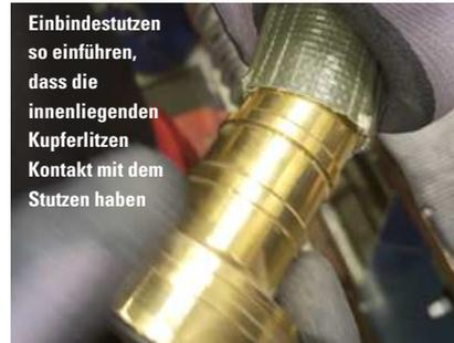
Einbindestutzen so einführen, dass die innenliegenden Kupferlitzen Kontakt mit dem Stutzen haben
