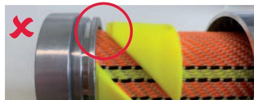
Der Absatz des Innenrings **muss** vor dem Pressvorgang komplett von Hand in den Stutzen formschlüssig eingeschoben werden (s. rechte Abbildung).
