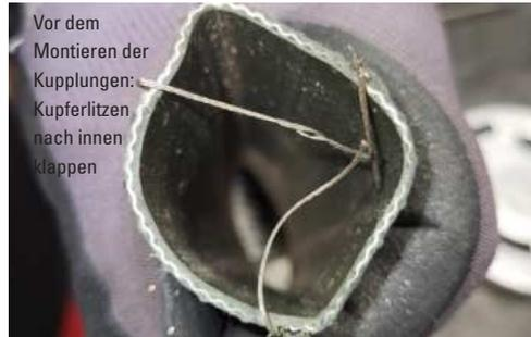
Vor dem Montieren der Kupplungen: Kupferlitzen nach innen klappen
