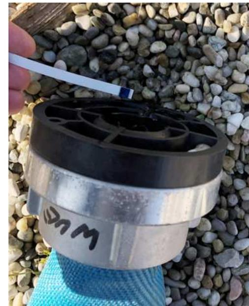
Nachweis des Desinfektionsmittels am Ende des Schlauchs
