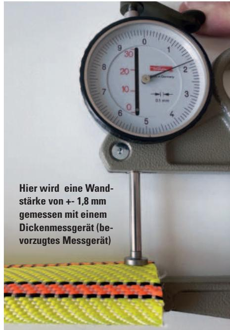
Hier wird eine Wandstärke von +- 1,8 mm gemessen mit einem Dickenmessgerät (bevorzugtes Messgerät)
