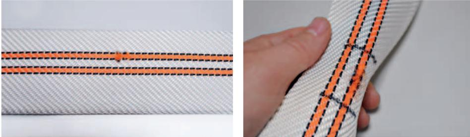
Betroffene Stelle lokalisieren und markieren. Löcher bzw. Schnitte bis zu einer Größe von 4 mm können repariert werden.
