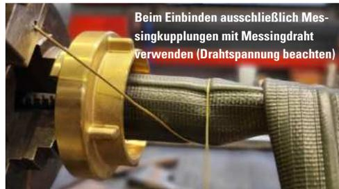
Beim Einbinden ausschließlich Messingkupplungen mit Messingdraht verwenden (Drahtspannung beachten)
