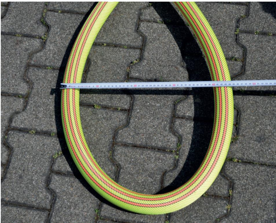
Der Biegeradius sollte aus Praxissicht möglichst gering sein. Je geringer der Biegeradius, desto weniger Knickstellen, die punktuelle Beschädigungen durch Abrieb und die Reduktion der Durchflussmenge verursachen.
