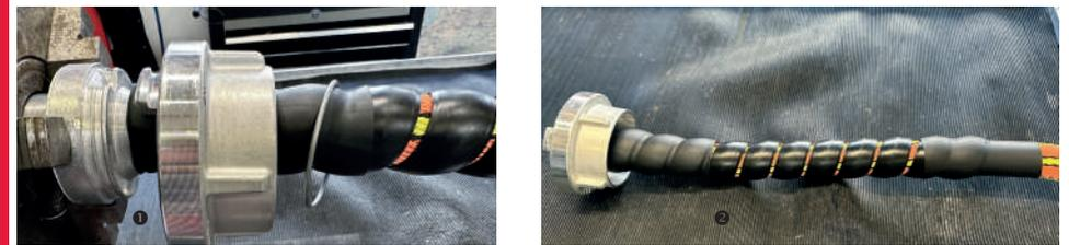
1 Knaggenpart und den Sperrring fest montieren 2 Fertig eingebundene Seite mit der Kunststoffknickschutzspirale
