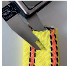
**Diese Messgerät ist nicht geeignet: zu kleine Messauflage**
