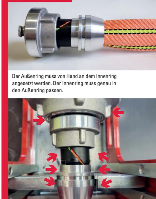
Der Außenring muss von Hand an dem Innenring angesetzt werden. Der Innenring muss genau in den Außenring passen.
