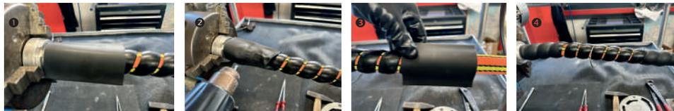
1 Schrumpfschlauch auf die Kunststoffknickschutzspirale am Stutzen vorne aufsetzen 2 mit einer Heißluftpistole (ca. 540°C) den Schrumpfschlauch langsam erhitzen 3 nun im Endbereich der Kunststoffknickschutzspirale einen Schrumpfschlauch aufsetzen und auch mit der Heißluftpistole langsam erhitzen 4 Endergebnis.
