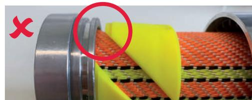
Der Absatz des Innenrings **muss** vor dem Pressvorgang komplett von Hand in den Stutzen formschlüssig eingeschoben werden (s. rechte Abbildung).
