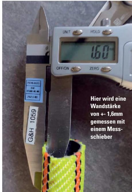
Hier wird eine Wandstärke von +- 1,6mm gemessen mit einem Messschieber
