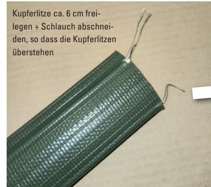
Kupferlitze ca. 6 cm freilegen + Schlauch abschneiden, so dass die Kupferlitzen überstehen
