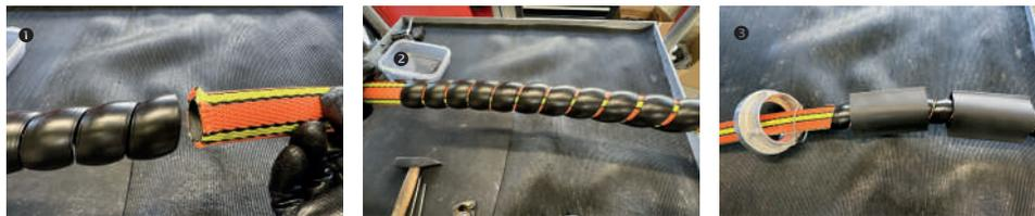
1+2 Kunststoffknickschutzspirale über den Schlauch ziehen, dabei vorsichtig die Spirale leicht aufdrehen 3 dann Knaggenpart, Sperrring und 2 Schrumpfschläuche über den Schlauch ziehen.
